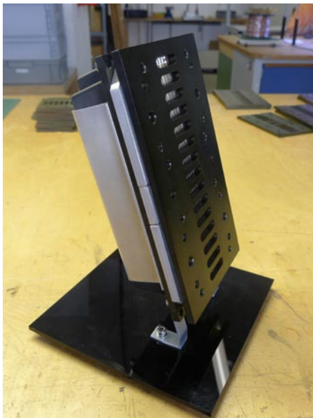
Mundorf ProAMT mit rückwärtiger Kammer und ohne vorgeseztes Horn.
